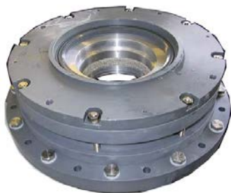
Rotationsbeschichtungsvorrichtung mit montierter Negativform (max Formaussen-Ø 250 mm)
